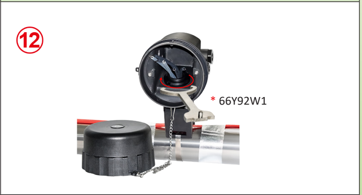
12 : Placer le joint dans le logement supérieur du pied, puis le boîtier au dessus. Orienter le boîtier selon la position souhaitée, puis placer et serrer l'écrou denté jusqu'au blocage.
