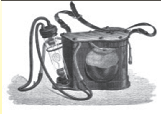
1862 Lampe électrique de mineur Dumas et Benoît
